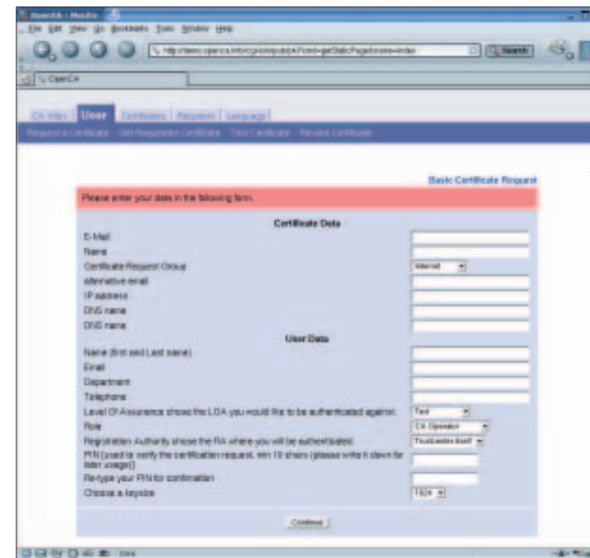
Abbildung 4: Formular zur Beantragung eines Zertifikats. Die abgefragten Elemente gehen in den DN beziehungsweise in die Erweiterungen des Zertifikats ein und sind frei konfigurierbar.
